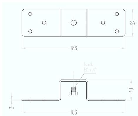
Base fija para punta captora 40 mm x 186 mm x 52 mm, en acero inoxidable para superficies planas, permite instalación con adhesivo y/o con pernos
