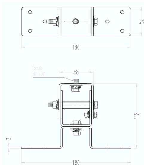
Base articulada para punta captora sistema de bisagra 119 mm x 186 mm x 52 mm, en acero inoxidable para superficies inclinadas y planas, permite instalación con adhesivo y/o con pernos
